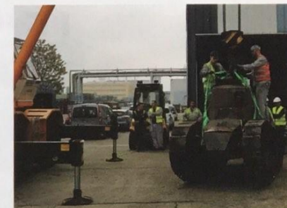
Des élingues sont mises en place pour pouvoir le lever avec une grue mise à disposition par la maintenance.
